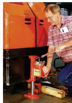
Les crics à patte de levage, série J, sont des crics particulièrement robustes utilisés ci-dessus pour le levage de véhicules.
