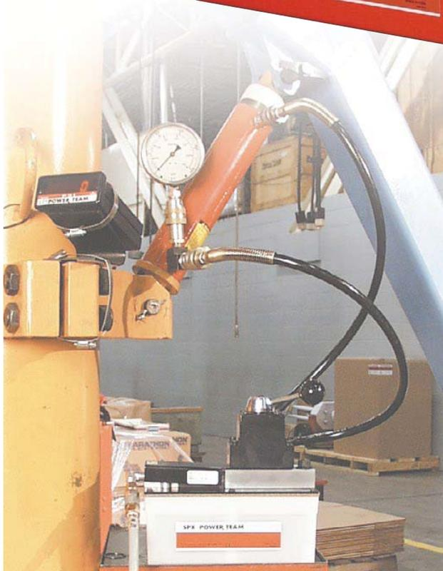
Pompe PA6D et vérin de 25 tonnes utilisés pour une fixation test.
