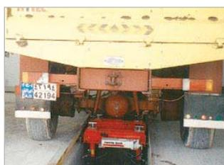
Pompe manuelle P300 et vérins de 10 tonnes pour le soulèvement d'un véhicule.
