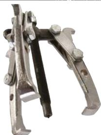
**Extracteurs à griffes:** Manuels ou hydrauliques. Pour plus de puissance et de facilité, utiliser un modèle hydraulique. Les deux types sont disponibles avec des configurations à 2 ou 3 griffes, et s'utilisent pour agripper la circonférence externe d'une pièce, ou avec un accessoire d'extraction interne pour roulement ou poulie par exemple. (pages 196-197, 210-211, 212-213, 222-223)
