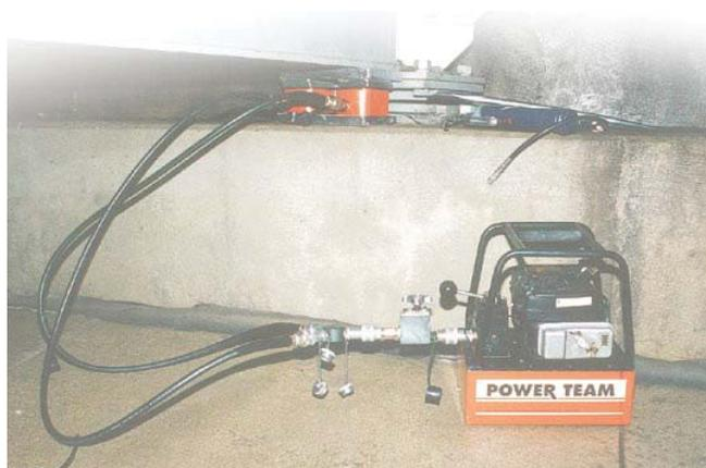
Les pompes hydrauliques avec moteur à essence telles que la PG303 fournissent de la force hydraulique à distance.
