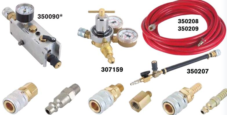
**Réf. 307159** – Valve de réduction de pression. Permet l'utilisation de gaz en bouteille pour alimenter les coussins (s'utilise avec des bouteilles CGA-580 Azote/Argon/Hélium). Équipé d'un raccord bouteille à l'entrée et d'un raccord interchangeable industriel 1/4" (femelle) à la sortie. Poids 0,1,8 kg.
